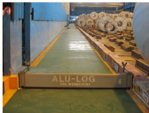
รูปที่ 3 การติดตั้งแผ่นบอร์ดกันน้ำตามจุดที่กำหนด Picture show method install waterproof board.
